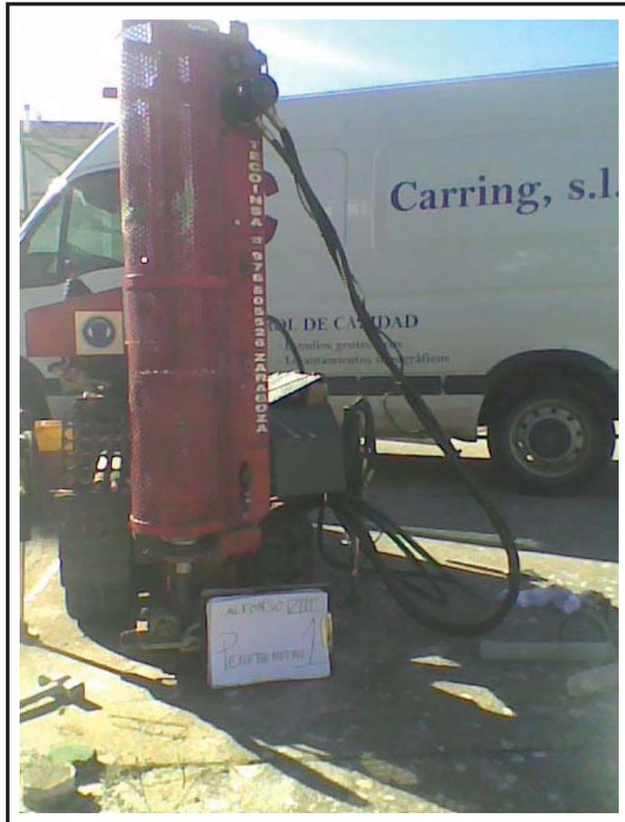
**Foto n° 1:** Ensayo de penetración dinámica superpesada n° 1.
